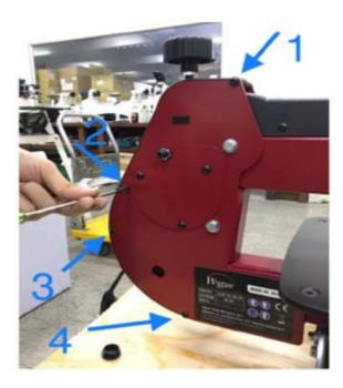
Déserrer uniquement, sans les enlever, la vis et l'écrou 1. Une clé Allen de 1/8 anglaise serait nécessaire, mais à défaut une N° 3 métrique peut faire l'affaire si vous débloquer premièrement l'écrou avec une clé à fourche de 10mm.
