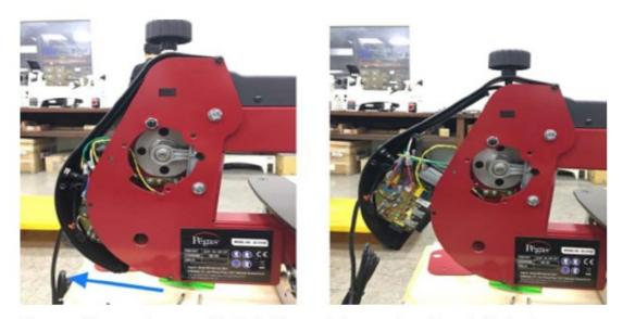
Tirez en arrière assez fermement tout le boîtier en plastique contenant la carte électronique, sans casser la partie du haut encore retenue par la vis 1 et le gros bouton moleté noir du réglage du bras.
